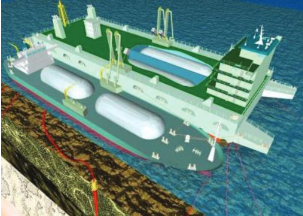
Kuva 13. Konseptikuva hiilidioksiditerminaalista. Kuvassa näkyy kaksi laivaan kiinnittynyttä siirtokäyttä, joiden avulla nestemäinen hiilidioksidi lastataan laivaan (Suzuki et al. 2013).
